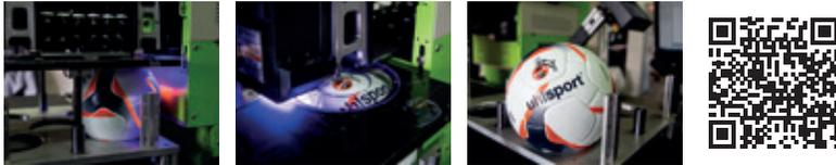
Das Logo wird mittels industriellem UV-Tintenstrahldrucker direkt auf die Balloberfläche gedruckt.
